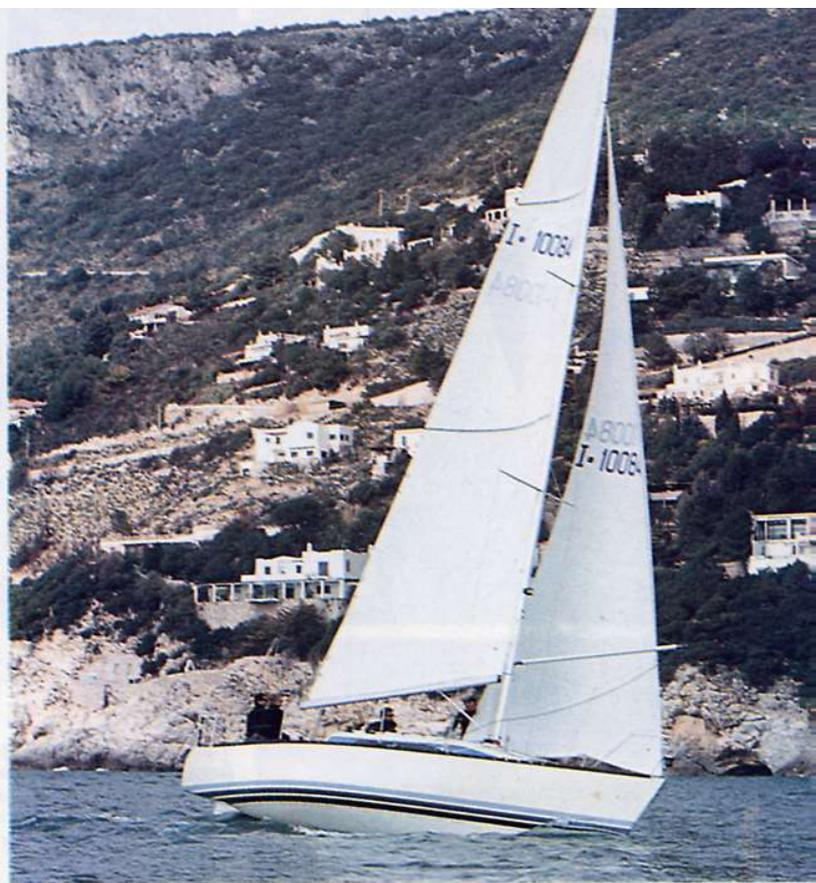
*La linea dello scafo è bassa sull'acqua e la tuga ben profilata. Ciò nonostante l'altezza della zona abitabile è notevole (m 1,88) e l'abitabilità è buona perchè l'arredamento disposto in senso longitudinale.*
